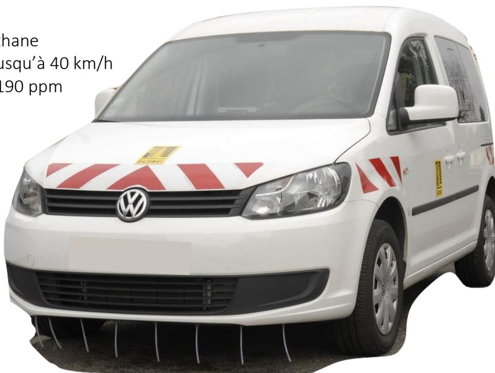
Le VSR Spectra permet la surveillance des réseaux de distribution de gaz naturel par simple passage du véhicule au-dessus des conduites de méthane enterrées.
